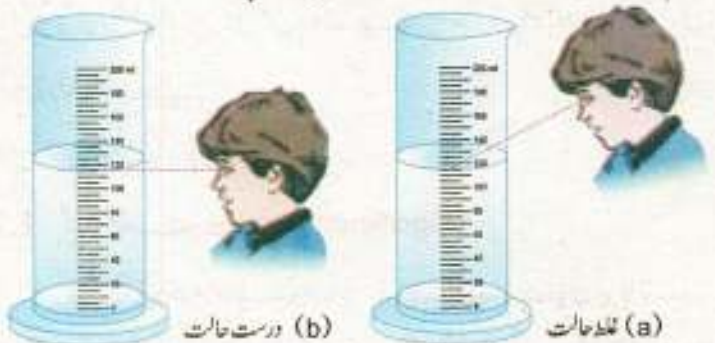
شکل 1.19 (a) آئکھ مائع کی سطح سے ہتھ ہونے پر مائع کا والیوم نوٹ کرنے کا لفظ طریقہ۔ (b) آئکھ مائع کی سطح کے مساوی رُکھ کر مائع کا والیوم نوٹ کرنے کا درست طریقہ۔
